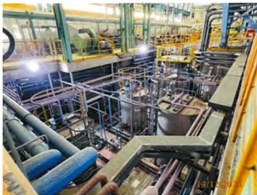
รูปที่ 3-27 บ่อรวบรวมสารละลายโครเมียม จากกระบวนการเคลือบผิว
