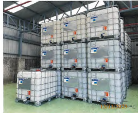
รูปที่ 3-24 ภาชนะและพื้นที่เก็บรวบรวมสารเคมี และกากตะกอนจากกระบวนการผลิต
